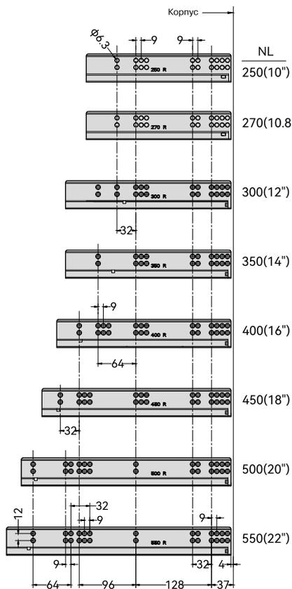
Низкий ящик, высотой 89 мм
