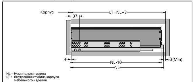
Инструкция по монтажу ящика Firmax Ultraslim на направляющих полного выдвижения
