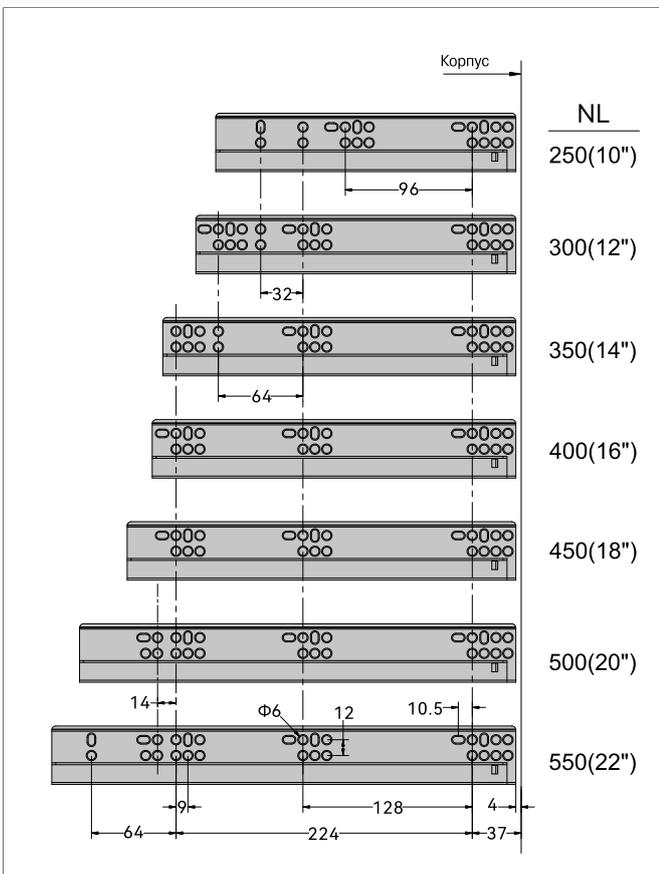
Низкий ящик, высотой 89 мм
