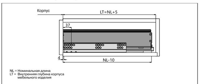
Инструкция по монтажу ящика Firmax Ultraslim на направляющих частичного выдвигения
